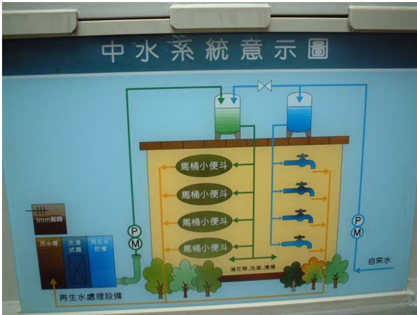
中水系統示意圖（圖片來源：攝自工研院）
